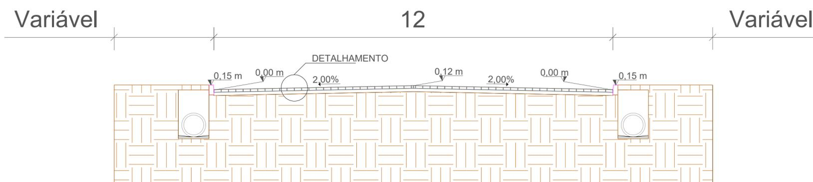
SEÇÃO TIPO DE PAVIMENTAÇÃO (BLOCO INTERTRAVADO)
