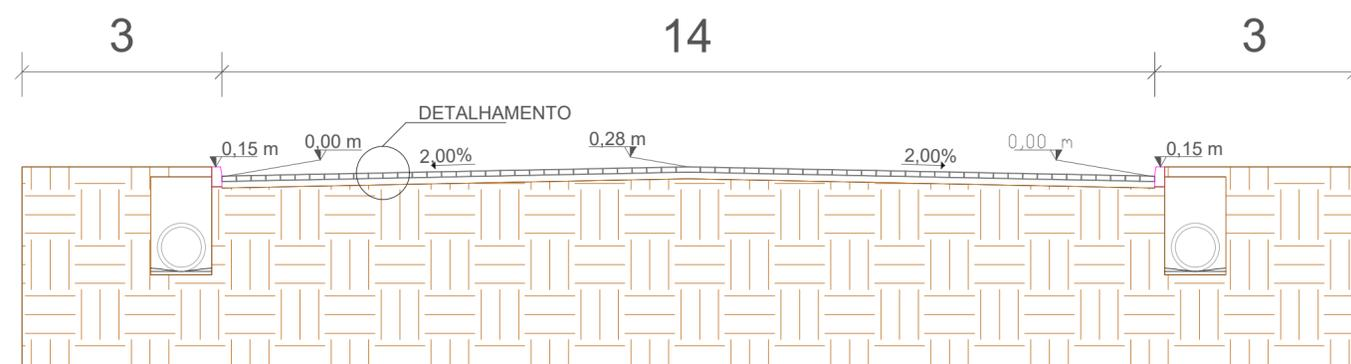
SEÇÃO TIPO DE PAVIMENTAÇÃO (BLOCO INTERTRAVADO)
