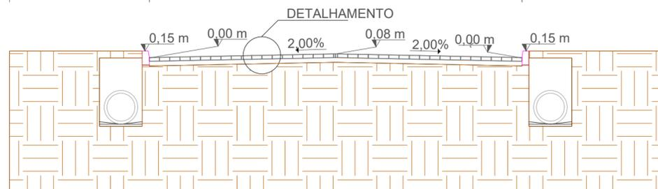
SEÇÃO TIPO DE PAVIMENTAÇÃO (BLOCO INTERTRAVADO)
