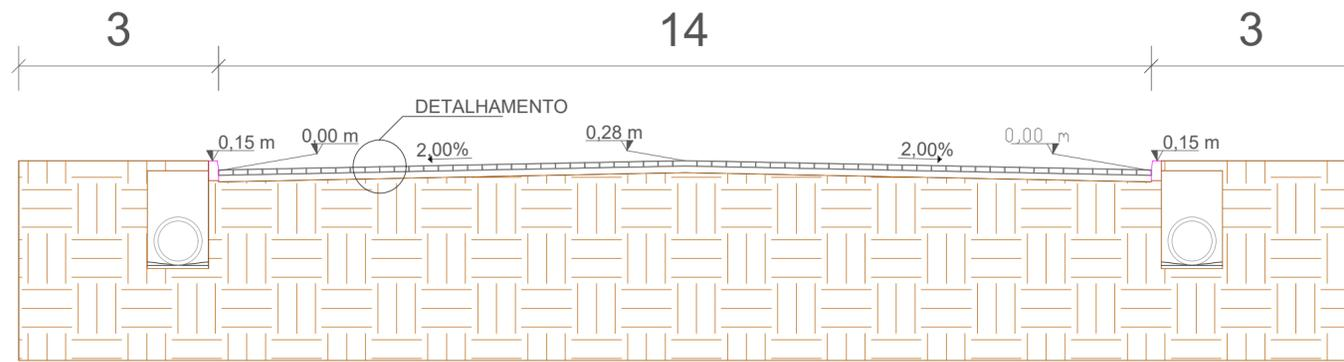
SEÇÃO TIPO DE PAVIMENTAÇÃO (BLOCO INTERTRAVADO)
