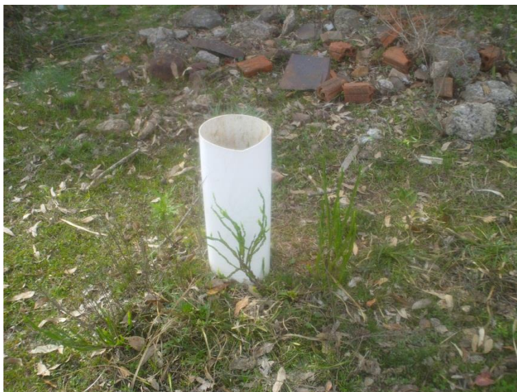
Imagem 147: Município de São Martinho da Serra - Piezômetro instalado na área do antigo lixão
