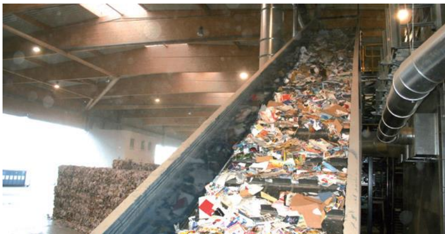
Figura 29: Sistema de seleção Sutco RecyclingTechnik.
